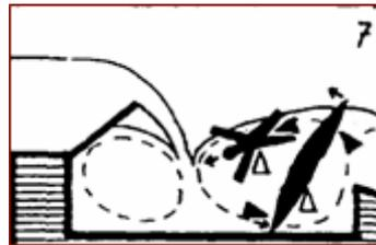
vollen Unterdruck kursieren oder, je nach dem sich einstellenden Kräftespiel zwischen Auftrieb und Strömung, zwischen Überfallstrahl, Deck und Grundwalze (vgl. das Boot in Abb. 8) oder im Zentrum von Deck oder Grundwalze rotieren. Aus eigener Kraft kann der Verunglückte sich jedenfalls nicht mehr befreien; und zwar auch dann nicht,
